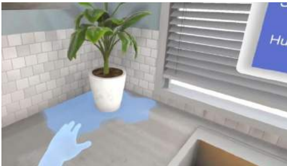
Рис. 2.13а. Система распознавания рук пользователя определяет кисть и создает ее 3D копию, сохраняя при этом общее расположение, размер, а также положение всех пальцев в виртуальном пространстве.
