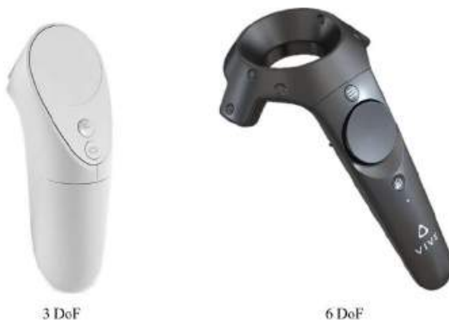
Рис. 1.11. Несмотря на схожие элементы управления, манипулятор виртуальной реальности с тремя степенями свободы (3 DoF, слева) не подходит для реализации систем дополненной виртуальности. Более продвинутые манипуляторы, обладающие шестью степенями свободы (6 DoF, справа) более универсальны, и подходят для дополненной виртуальности
