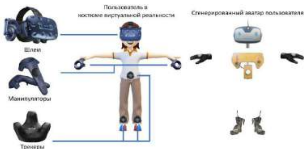
Рис. 1.12. Один из вариантов дополнения виртуальности модифицированной копией – создание аватара пользователя, с помощью костюма виртуальной реальности. За положение головы отвечает шлем, движение рук регистрируют манипуляторы, а торс и ноги позиционируются с помощью трех трекеров.
