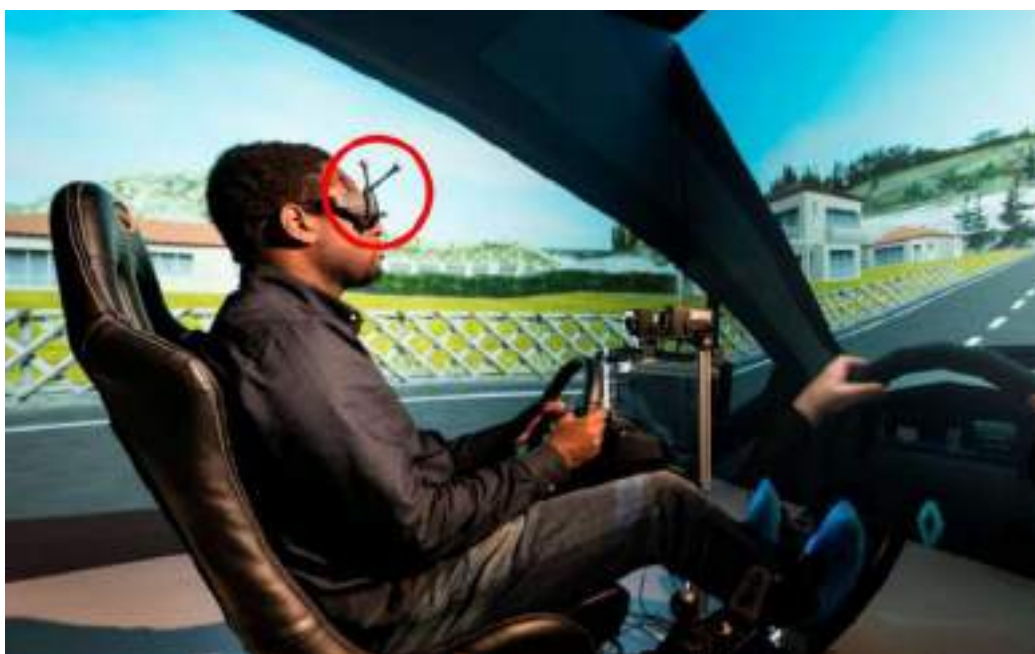
Рис. 1.10. Даже при реализации дополненной виртуальности без шлема требуется отслеживать положение головы пользователя по 6 степеням свободы (6 DoF) для корректного проецирования изображения.
