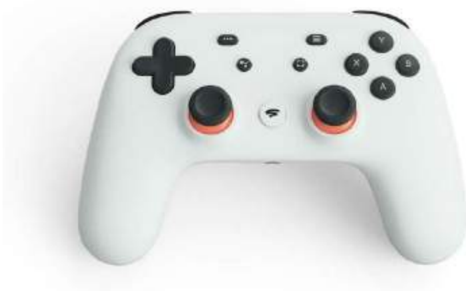
Рис. 1.7. Большинство геймпадов не обладает какими-либо датчиками положения в пространстве, что не позволяет полноценно работать с виртуальным миром.
