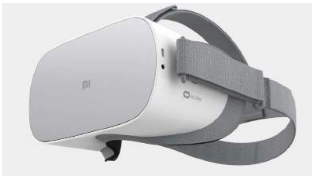
Рис. 1.6. Шлем виртуальной реальности Oculus Go не обладает внешними датчиками для отслеживания положения в пространстве и поддерживает только 3 степени свободы (3 DoF).
