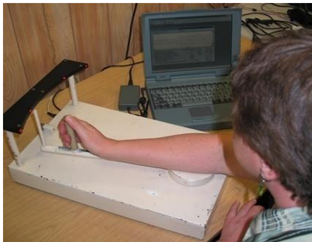
Рисунок 5. Прибор для оценки ЛП простой сенсомоторной реакции на световой (мигание светодиода) и звуковой (щелчок) стимулы
